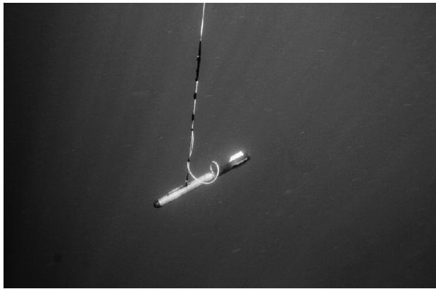
写真8 ソナー曳航体の海中状況
