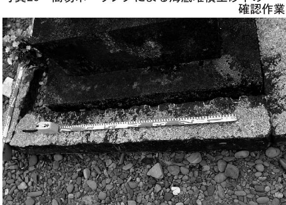
写真31 墓地で確認した矢穴のある花崗岩製の石材
